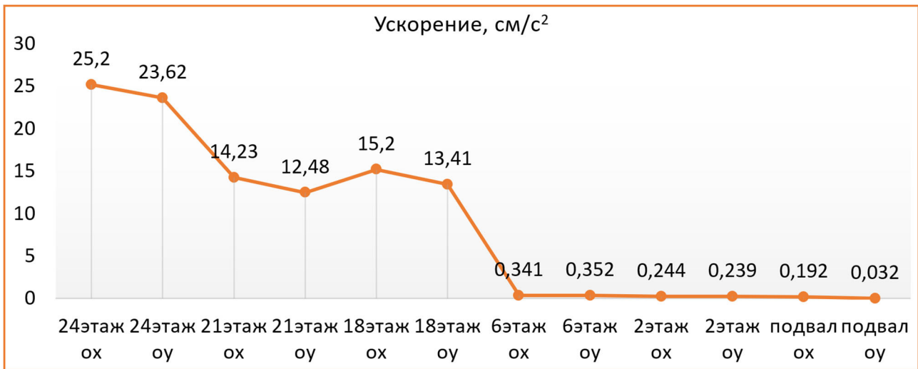
Рисунок 2 – График величин ускорений сдвиговых деформаций по этажам здания по удаленным колебаниям земной поверхности
