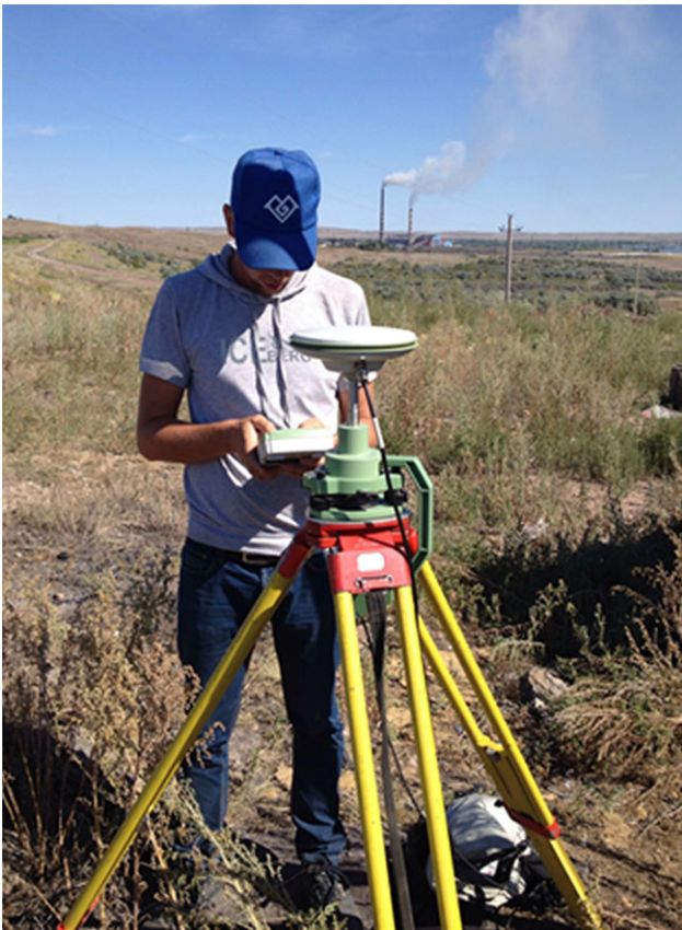
1-сурет – Топар МАЭС бөгетін егжей-тегжейлі түсіріс кезіндегі далалық геодезиялық жұмыстар
