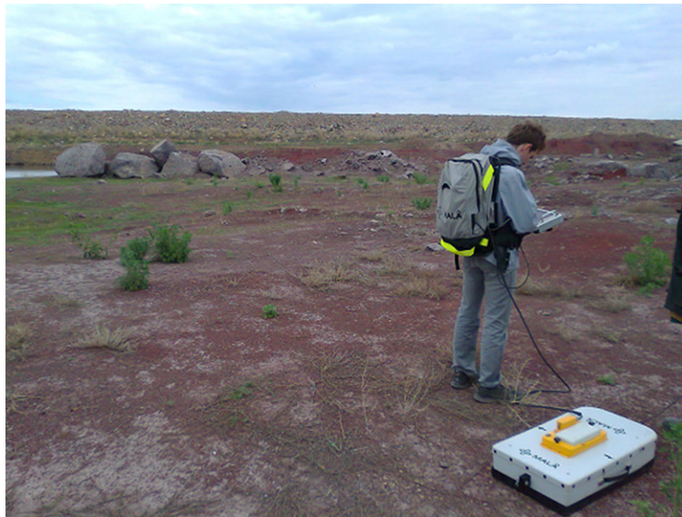
5-сурет – 46 секциясында тостағанның түбін георадарлық зондау кезіндегі далалық жұмыстар
