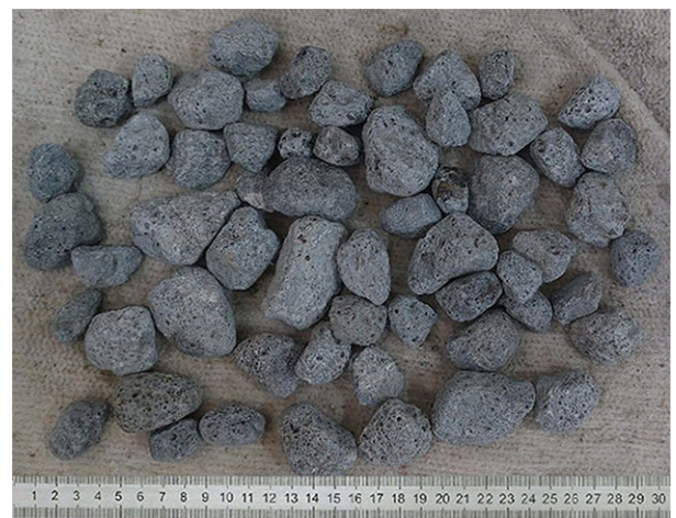
Рисунок 2 – Зерна шлакового щебня после избирательного дробления
