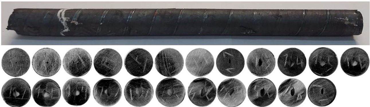
Рисунок 2 – Прокатанный образец с дефектом (вверху) и диски распила поперечных сечений содержащего дефект участка образца (внизу)
