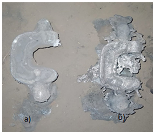
а) полученная с применением смеси ХТС; б) полученная с применением смеси ПГС.
