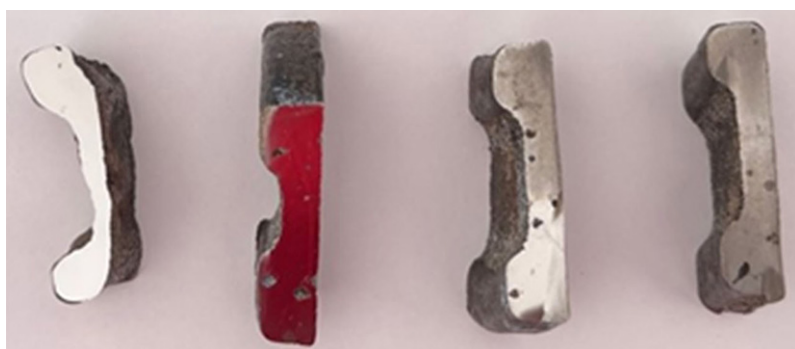
Рисунок 4 – Шлифы из стали 35Л, полученные на формах ХТС и ПГФ
