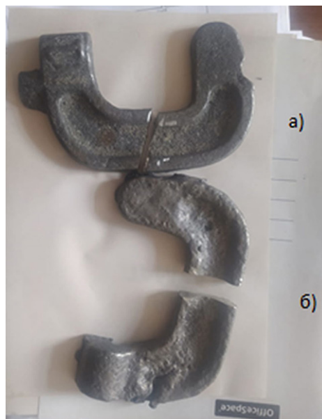
а) полученная с применением смеси ХТС; б) полученная с применением смеси ПГС.
