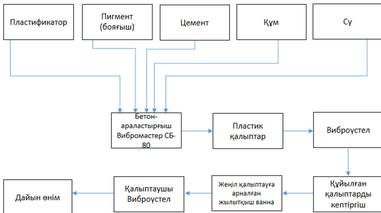
1-сурет – Ресейлік «Құрылыс технологиясы» фирмасы ұсынған бетонды төсеніштер алу технологиясының сызбанұсқасы
