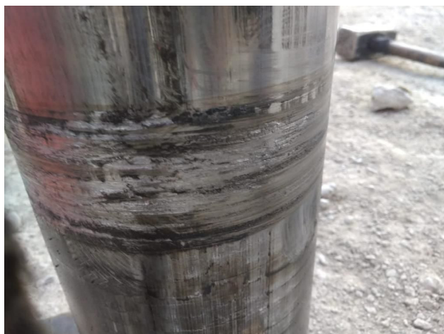
Рисунок 2 – Царапины и задиры на поверхности штока
