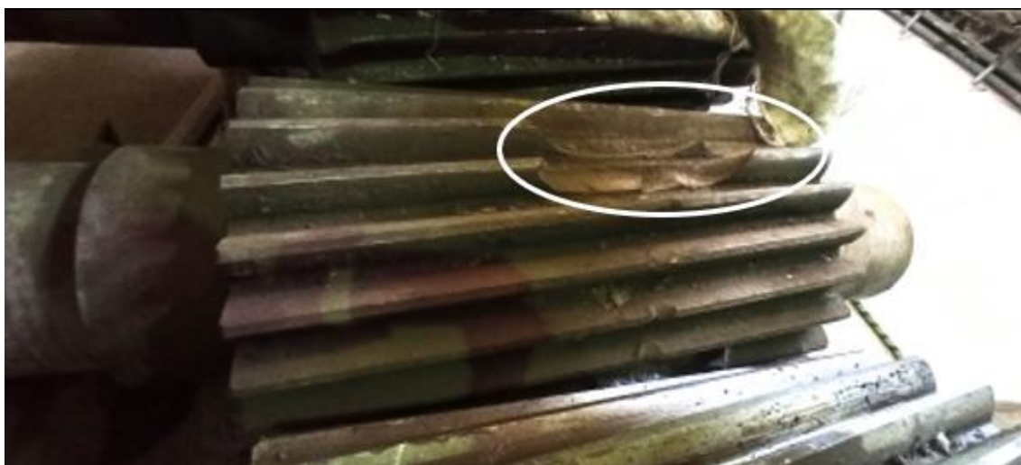
в) тістердің тозуы: сыну ұзақтығы 345мм
