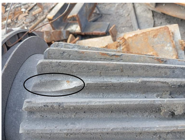
а) эвольвенталы профильдің пластикалық деформациялануы
