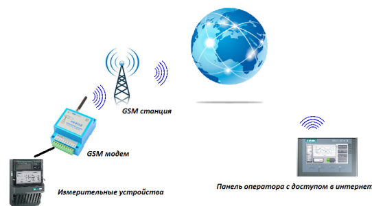
Рисунок 2 – Функциональная схема работы модема в режиме GPRS
