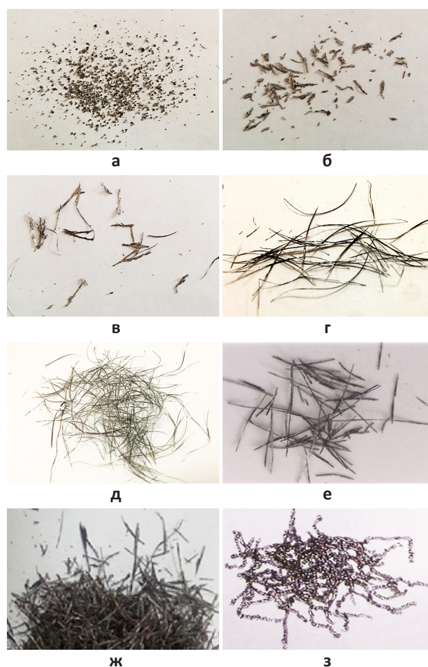
а, б – стружки полученные при обработке стали 20Х, Ø120 мм; в, г, д – стружки, полученные при обработке стали 45, Ø240 мм; е, ж – стружки, полученные при обработке антифрикционного чугуна АЧК-1; з – стружки, полученные при обработке стали 35Л, Ø230 мм
