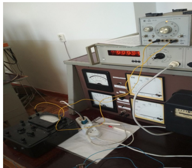
Рисунок 3 – Измерение параметров накладного трансформаторного ВТП
