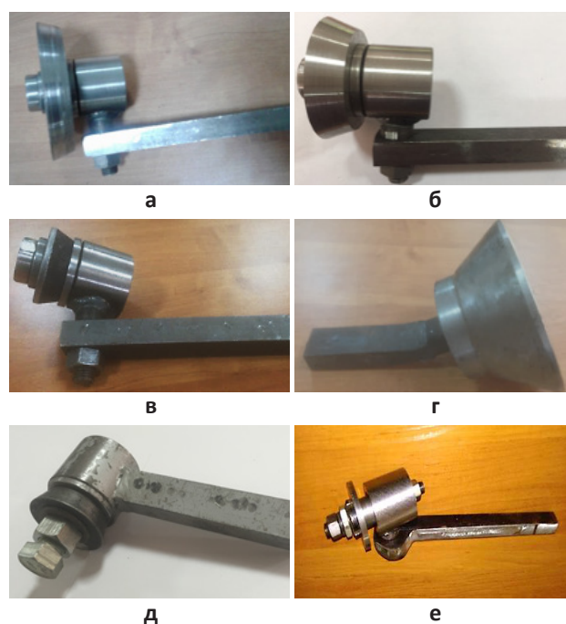
а,б,в,г,д – инструменты для обработки наружных цилиндрических поверхностей; е – инструмент для обработки внутренней поверхности; а – чашечный резец изготовлен из стали HARDOX; б – чашечный резец изготовлен из стали 65Г; в, д – чашечный резец изготовлен из стали 20Х; г – чашечный резец изготовлен из ВЧ40; е – чашечный резец изготовлен из стали 9ХС
