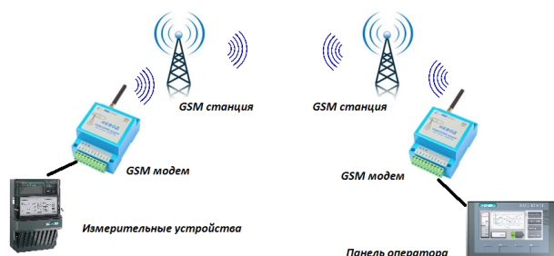
Рисунок 1 – Функциональная схема работы модема в режиме CSD
