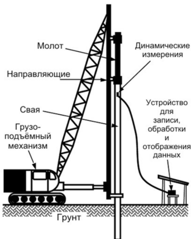
Рисунок 2 – Полевые испытания сваи методом PileDrivingAnalyzer [3]
