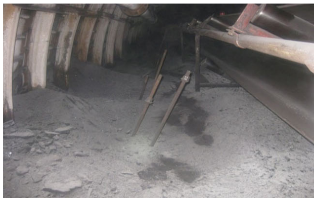
а – Қарағанды көмір бассейнінің «Шахтинск» шақтысында табан жыныстарды қарнақтармен бекіту; б – тәптіштеу
