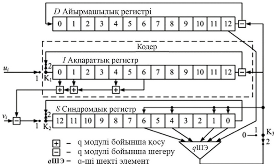
2-сурет – Символды КШД (қКШД) схемалық жүзеге асырылуы
