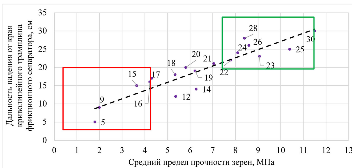
Рисунок 4 – Зависимость дальности падения зерен шлакового щебня от края криволинейного трамплина фрикционного сепаратора от среднего значения их предела прочности
