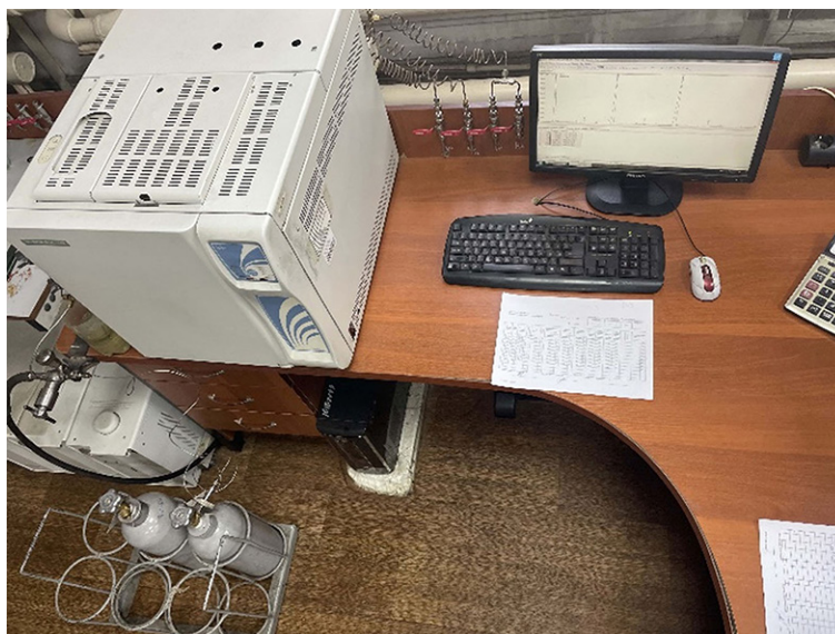
Рисунок 3 – Хроматографический комплекс на базе газового хроматографа «Хроматэк-Кристалл 5000.2»
