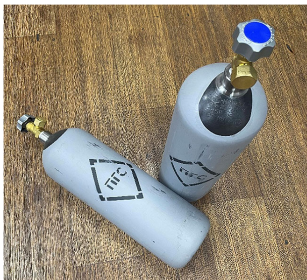
Рисунок 1 – Баллоны из углеродистой стали емкостью 5 л. с латунным вентилем
