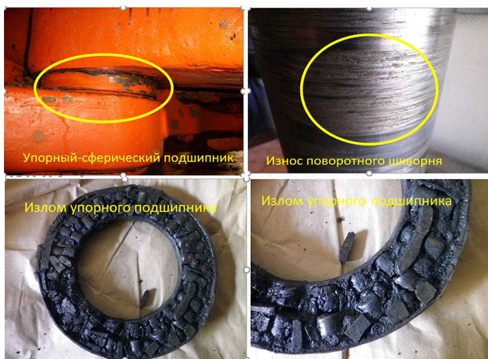
Рисунок 7 – Дефекты подшипниковых узлов переднего моста автосамосвала
