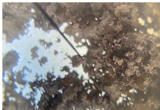
5-сурет – 28 тәулік ауада сыналған мұнай шламы қосылған портландцемент үлгісінің микроқұрылымы
