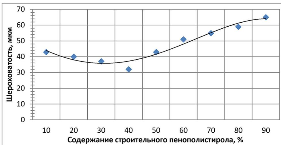
Рисунок 1 – График зависимости шероховатости отливки от содержания строительного пенополистирола
