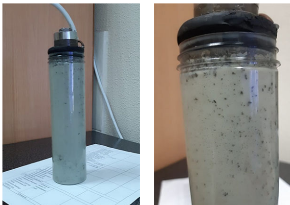
Рисунок 2 – Очищение СОЖ ультразвуком
