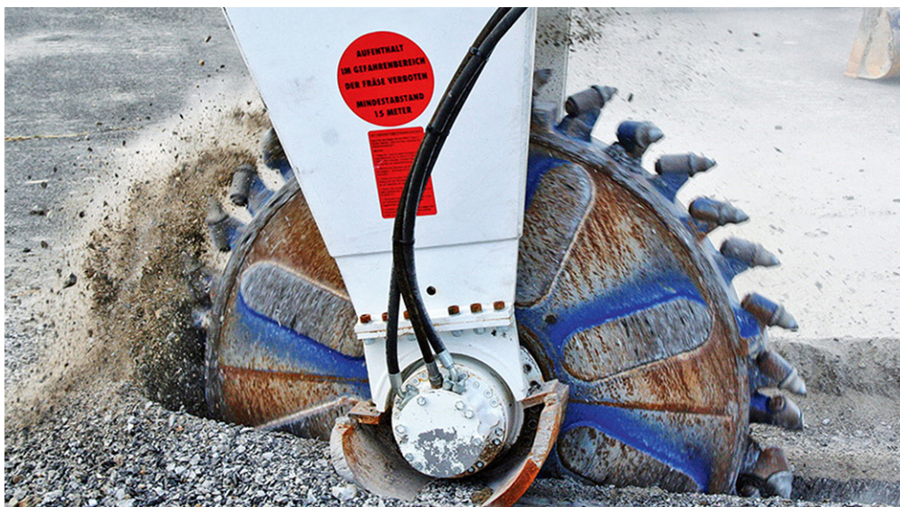
Рисунок 5 – Резание грунта дисковой фрезой
