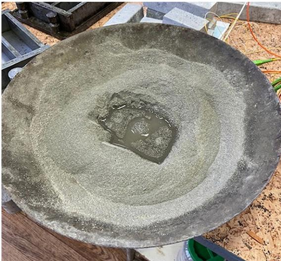
Рисунок 2 – Процесс замешивания цементного теста
