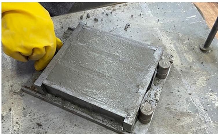
Рисунок 4 – Процесс виброобработки цементных балок
