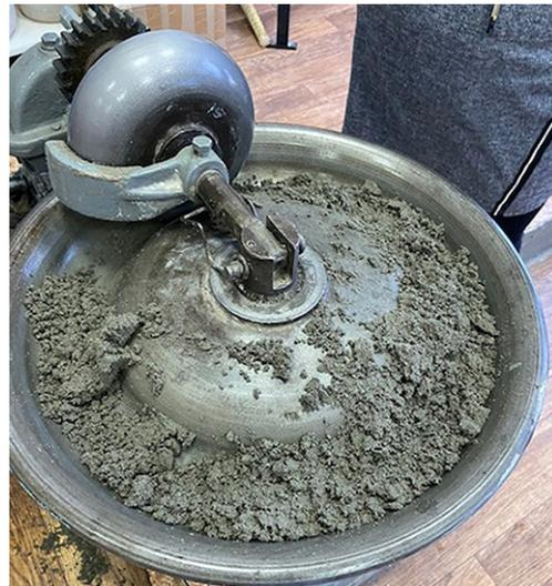
Рисунок 3 – Процесс перемешивания в бетономесительной машине
