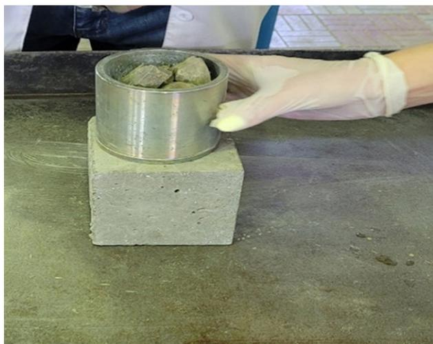
Рисунок 4 – Форма для определения дробимости
