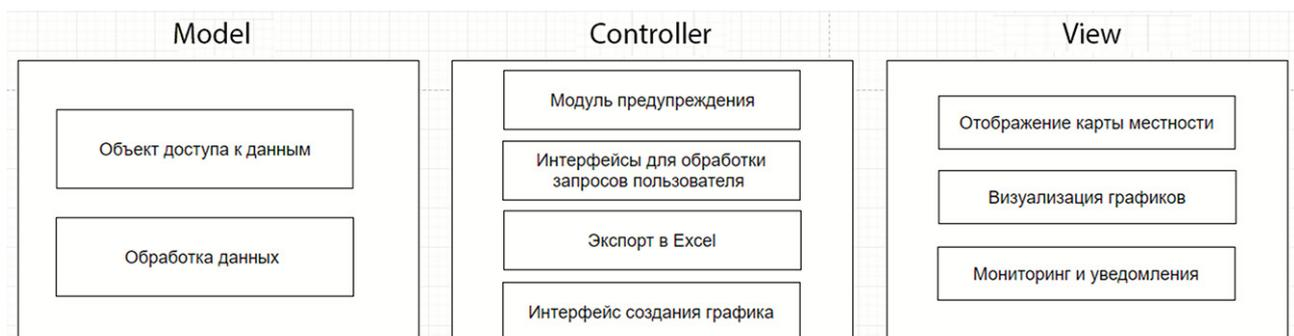
Рисунок 4 – Архитектура «Модель-Представление-Контроллер» информационно-управляющей системы
