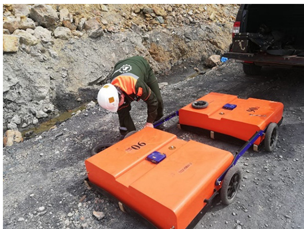
Рисунок 1 – Сборка георадара «ОКО-2»
