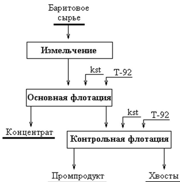
Рисунок 1 – Простая схема флотации баритового сырья
