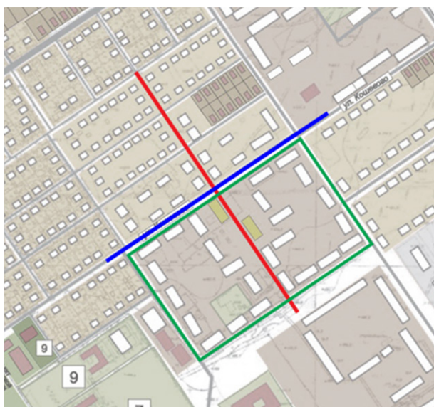
Рисунок 1 – Схема жилого квартала с нанесением композиционных градостроительных осей и определением планировочного центра участка
