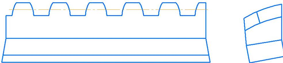
Рисунок 3 – Режущая рейка
