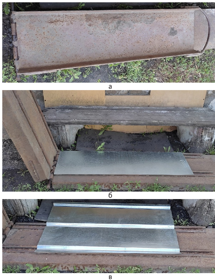
а – общий вид штампа; б – начальная стадия штамповки узкой заготовки с 2 гребнями; в – конечная стадия штамповки широкой заготовки с 3 гребнями
