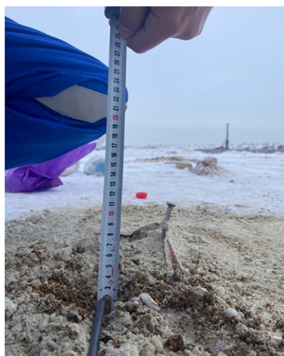
Рисунок 1 – Фрагмент засыпки химического реагента с использованием негашеной извести и измерением глубины оттаивания
