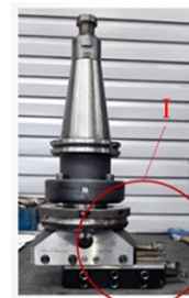
а – расточной резец для черного растачивания; б – расточной резец для чистового растачивания Рисунок 6 – Инструменты для обработки отверстий \varnothing 295 мм
