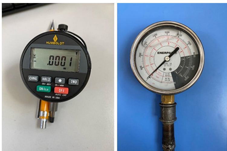
Рисунок 5 – Измерители перемещения и нагрузки
