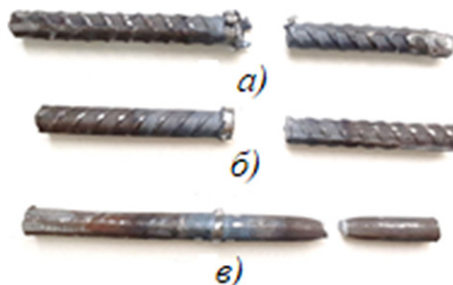
5-сурет – Сынаудан кейінгі арматуралық өзектердің кейбір үлгілері
