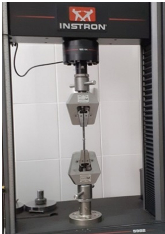
4-сурет – Үлгілерді сынау процесі
