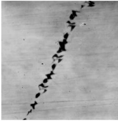
Рис. 3. Микроструктура стали с внутренним дефектом — надрыв металла. До травления.  $\times 500$
