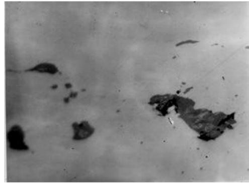
Рис. 5. Оксидные включения в участках. До травления.  $\times 630$
