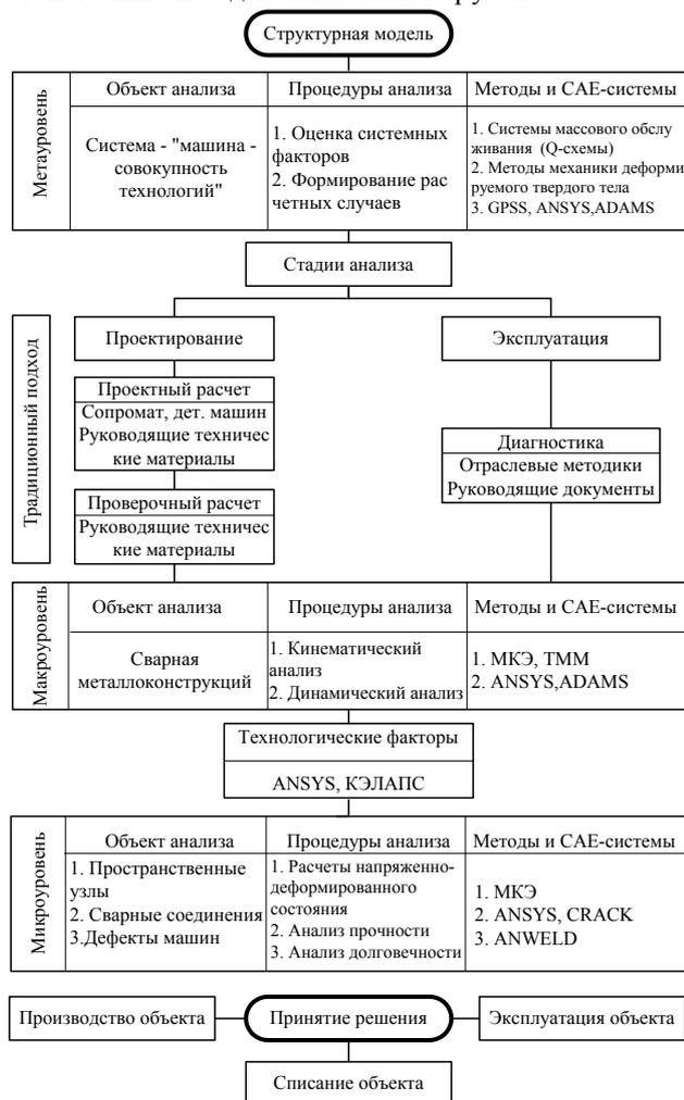
Рис.1. Иерархия моделей автоматизированного инженерного анализа
