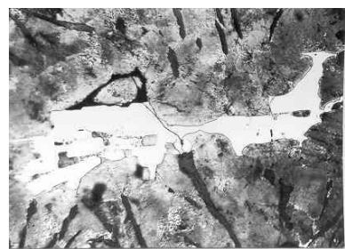
Рис. 4. Микроструктура рабочего слоя изложницы, подвергнутой поверхностному модифицированию борной кислотой: а — на глубине 1 мм; б — на глубине 4-5 мм; в — на глубине 6-7 мм. Травлено азотной кислотой. \times 10
