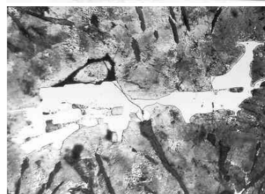
Рис. 4. Микроструктура рабочего слоя изложницы, подвергнутой поверхностному модифицированию борной кислотой: а — на глубине 1 мм; б — на глубине 4-5 мм; в — на глубине 6-7 мм. Травлено азотной кислотой. \times 10
