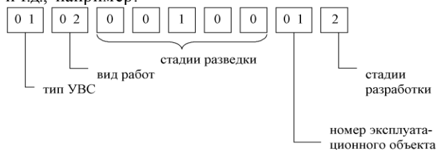
Рис. 2. Схема второго этапа классификации подсистемы «Технология» по стадиям проводимых работ (УВС)
