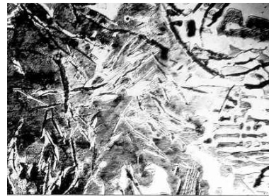
Рис. 2. Микроструктура чугуна рабочего слоя отливки, легированного карбидом бора. Травлено. ×10
