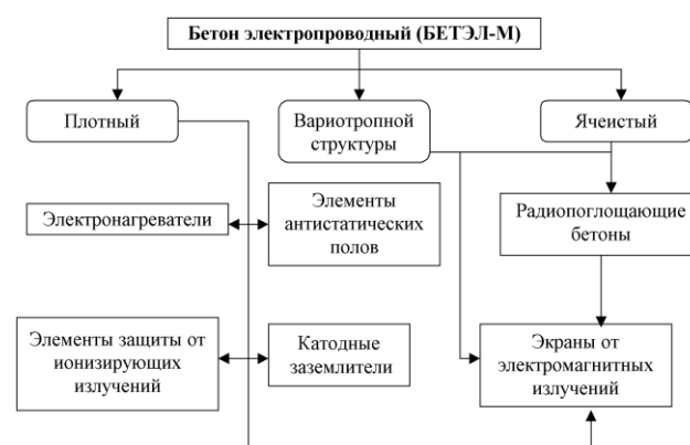
Рис. 2. Классификация и область использования металлонасыщенных электропроводных бетонов
