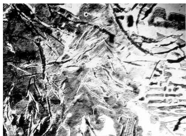
Рис. 2. Микроструктура чугуна рабочего слоя отливки, легированного карбидом бора. Травлено. \times 10
