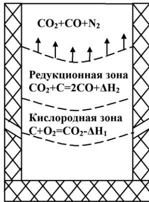
Рис. 1. Горение топлива в холостой колоше вагранки
