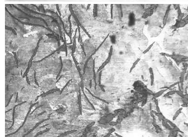
Рис. 3. Микроструктура рабочего слоя отливки, подвергнутой поверхностному модифицированию бурой: а — на глубине до 2 мм; б — на глубине 3 мм; в — на глубине 7 мм. Травлено азотной кислотой. \times 10
