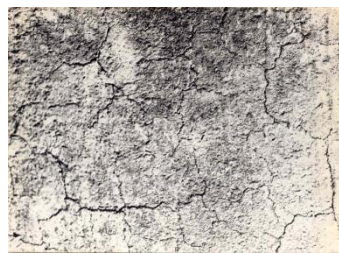
Рис. 4. Вид сетки разгара на стенке изложницы №478 после наливов ( \times 0,5 ): а) контрольный участок; б) участок, легированный феррохромом, фракцией до 1 мм.
