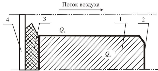
Схема отвода тепла от паза обмотки якоря тягового двигателя электровоза: 1 — проводники обмотки якоря; 2 — корпусная изоляция; 3 — клинья; 4 — зубцы;  $Q_m$  — электрические потери;  $Q_c$  — магнитные потери
