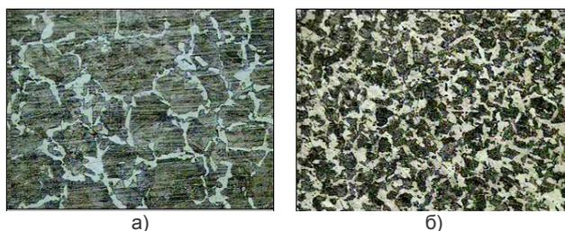
Рис. 1. Микроструктура стали 45: а — микроструктура исходной заготовки стали 45; б — микроструктура стали 45 после третьего цикла обжатия в трапециевидных бойках  $\alpha=30^\circ$
