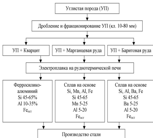
Схема получения комплексных сплавов из углистых пород Экибастузского бассейна
