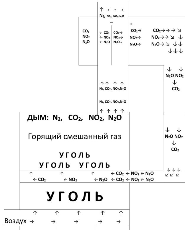
Схема организации и использования оборотного дыма для сокращения выбросов парниковых газов и повышения КПД угольной топки
