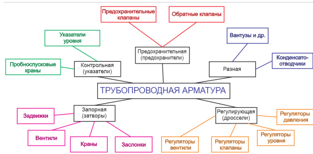
Рисунок 2 – Классификация трубопроводной арматуры
