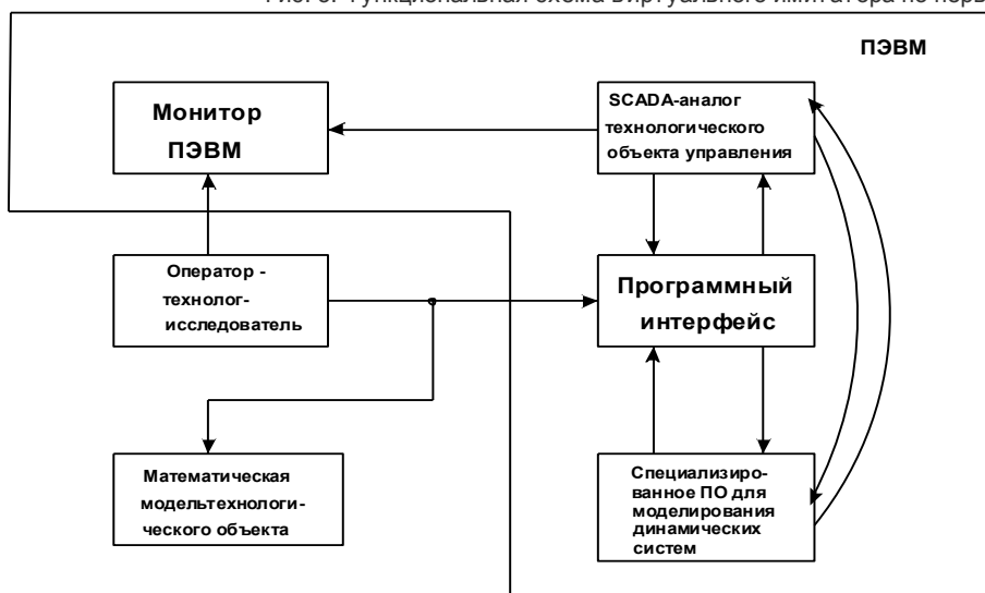
Рис. 4. Функциональная схема виртуального имитатора по второму варианту
