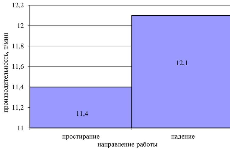
Рис. 2. Зависимость производительности комбайна по скорости крепления от направления работы лавы
