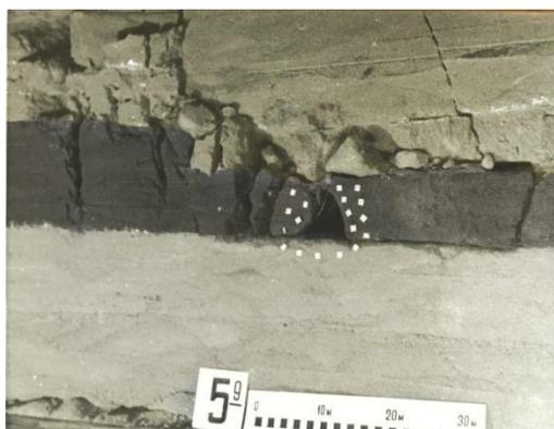
Рисунок 2 — Физическое моделирование геомеханических процессов при проведении и поддержании выемочных выработок: а — общий вид модели; б — деформационный процесс в пределах выемочного столба; в, г — деформации во вмещающих породах до и после прохода лавы
