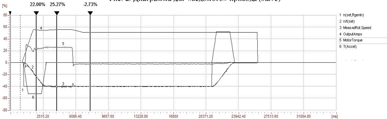
Рис. 3. Диаграмма обрыва вала у привода № 1 (master)
