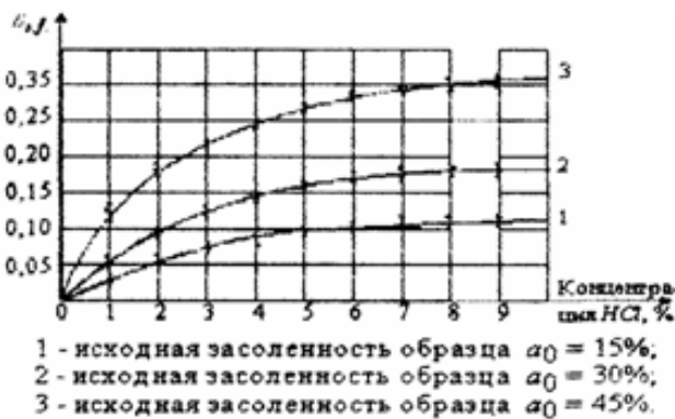
Рис. 1. Развитие относительной суффозионной сжимаемости в песчаных образцах засоленных карбонатами под действием растворов соляной кислоты P = 0,2 МПа
