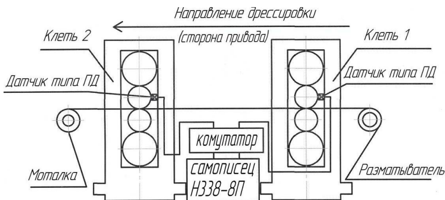
Рис. 1. Схема расположения датчиков линейных перемещений и установки регистрирующей аппаратуры на клетях №1 и №2 ДПДС-1400 (вид со стороны привода) [4]
