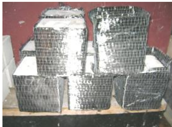
Рис. 2. Образцы-кубы, армированные углеродным фиброволокном MBT-MBrase
