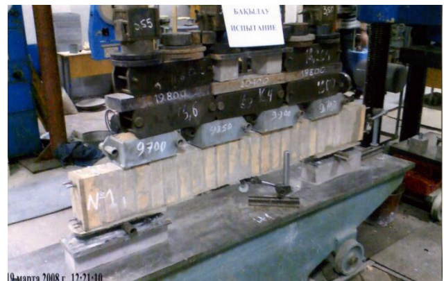
Рис. 4. Заключительный этап нагружения перемишки
