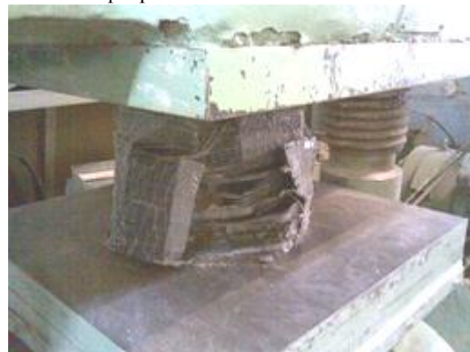
Рис. 3. Испытания экспериментальных образцов-кубов, изготовленных с расчетом на класс В22,5 и В40 и усиленных 2 слоями MBT-MBrase в возрасте 14 суток
