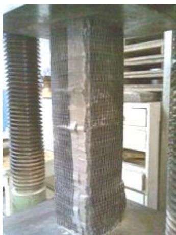
Рис. 4. Испытания экспериментального призмного образца, армированного углеродным фиброволокном MBT-MBrase
