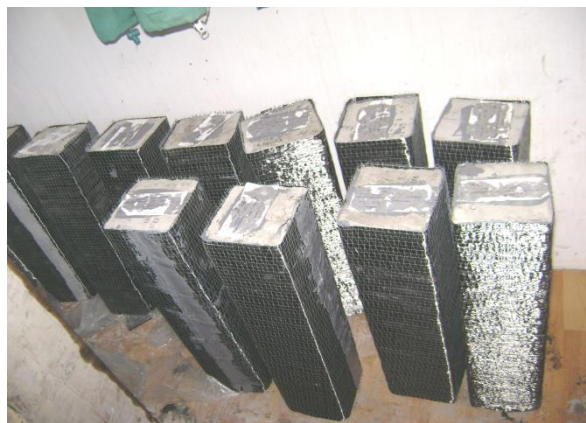
Рис. 1. Призмные образцы, армированные углеродным фиброволокном MBT-MBrase
