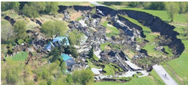
Рисунок 2 – Оседание земной поверхности над горными выработками
