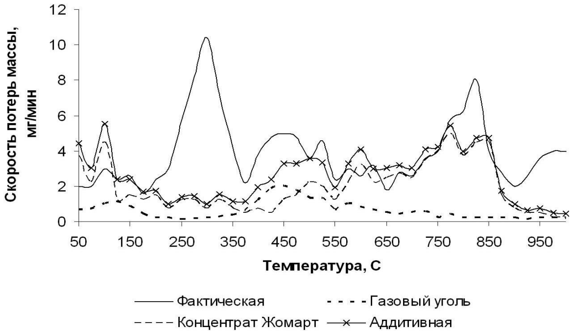
Рисунок 4 – Скорость потерь массы при непрерывном нагреве с заданной скоростью (10 °С/мин) в атмосфере аргона
