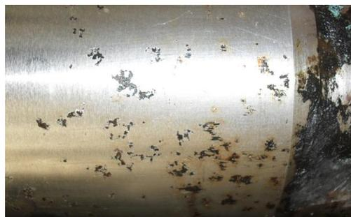
Рисунок 4 – Абразивный износ и коррозия штоков механизированных крепей
