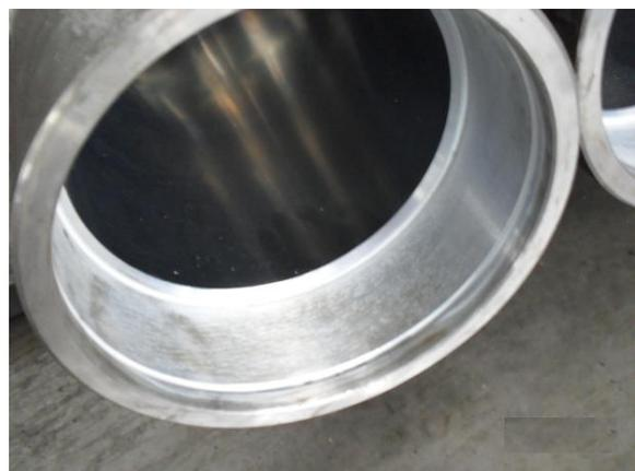
Рисунок 1 – Цилиндры механизированной крепи 2ОКП70К с хромовым гальванопокрытием
