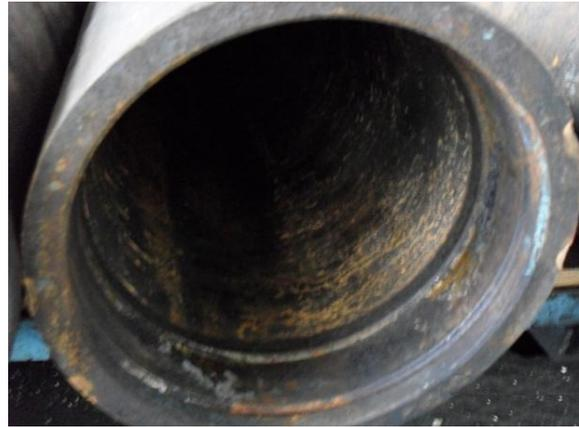
Рисунок 2 – Цилиндры механизированной крепи 2ОКП70К без хромового гальванопокрытия со следами коррозии
