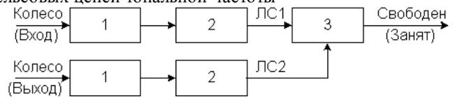
Рисунок 2 – Структурная схема системы счета осей
