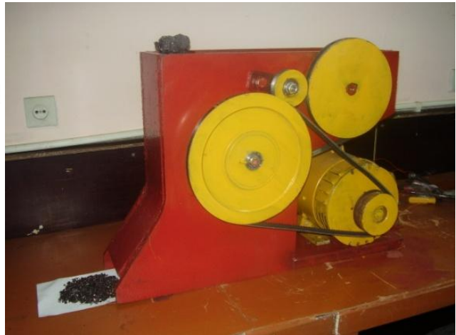
1 – неподвижная щека; 2 – подвижная щека; 3 – станина дробилки; 4 – маховик; 5 – шатун; 6 – электродвигатель; 7 – клиноременная передача; 8 – ось подвеса подвижной щеки; 9 – загрузочное отверстие; 10 – разгрузочное отверстие; 11 – узел шарнирного соединения шатуна и подвижной щеки; 12 – отверстия для переустановки шатуна
