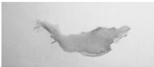
Рисунок 3 – Ватообразный нарост, образовавшийся по краям стенок тигля
