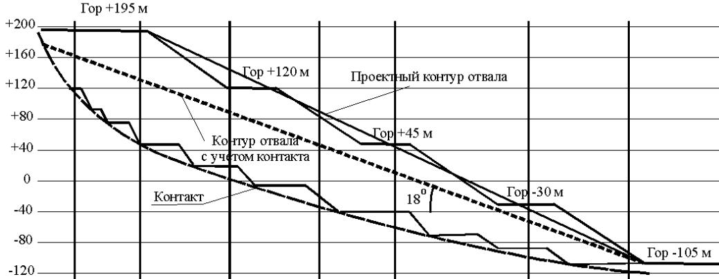
Рисунок 3 – Проектный профиль откоса внутреннего отвала № 2
