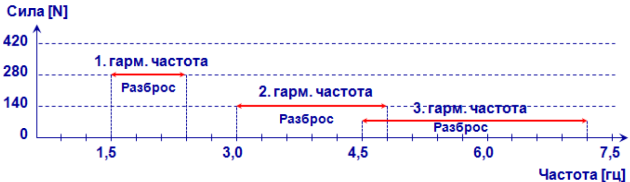
Рисунок 5 – Колебания несущих конструкций в результате ходьбы
