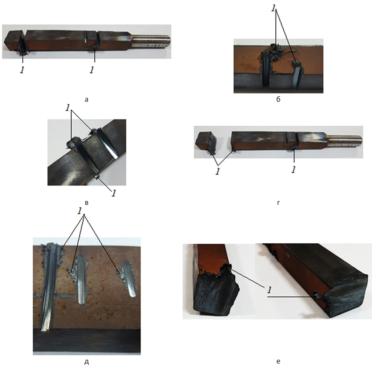
а, б, в – обработка канавок; г – отрезка и обработка канавок; д – обработка закрытых шпоночных пазов; е – отрезка; 1 – заусенец
