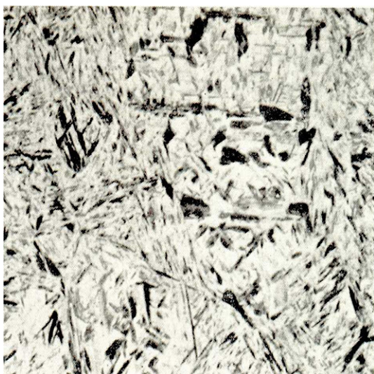
Рисунок 2 – Структура стали 12ХН3А, обработанной по режиму: цементация при температуре 900°C с закалкой при 800°C и отпуском при 180°C
