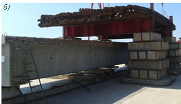
а) вид с торца железобетонной балки; б) вид с боку железобетонной балки и загрузочной установки
