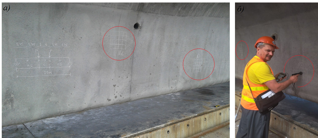
а) места определения прочности бетона в балке; б) работа с прибором
