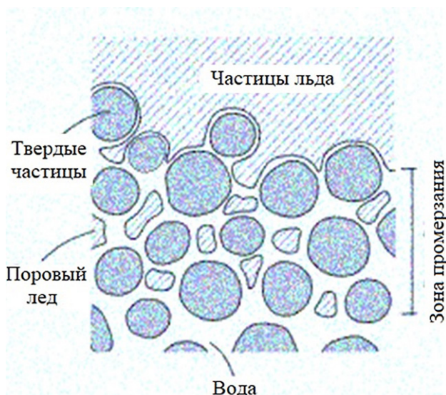
Рисунок 1 – Процесс промерзания грунта
